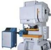
高速冲床是采用一体化的特殊铸铁合金,高刚性及抗震性。滑块以长型导路设计,配备滑块平衡装置,确保运转精密与稳定。所有抗磨损元件均以电子式定时自动润滑系统,如缺乏润滑油,冲床将全自动停止。先进、简易的操控系统,确保滑块运转及停...
